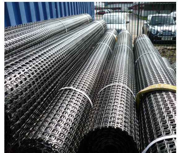
Fig. 2: Storing Abgrid geogrid
