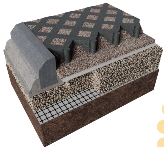
ABG Truckcell 80 build-up
